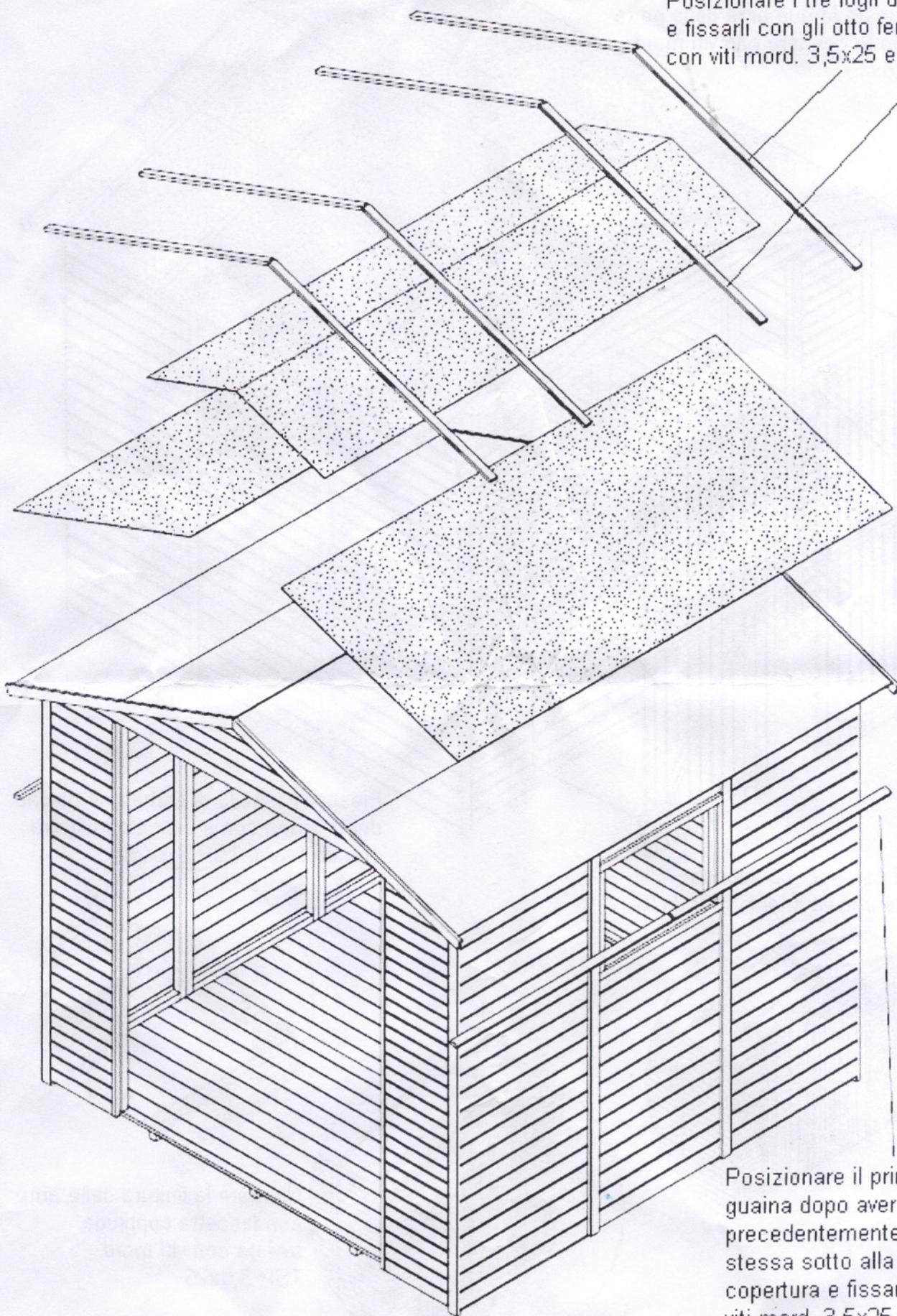
Posizionare il primo foglio di guaina dopo aver precedentemente piegato la stessa sotto alla falda di copertura e fissare con viti mord. 3,5x25
